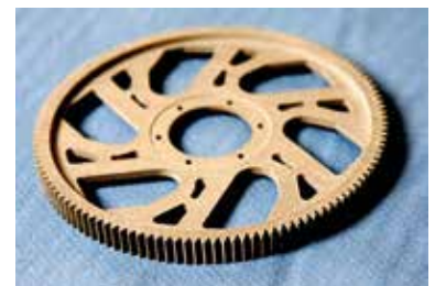
3D-tulostusmenetelmällä tuotettu metallikappale.
