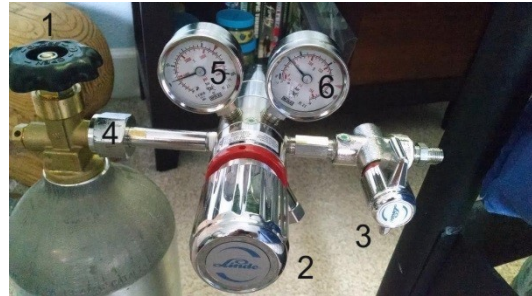
Kuva 3. Paineensäädin kiinnitettyä kaasupulloon
