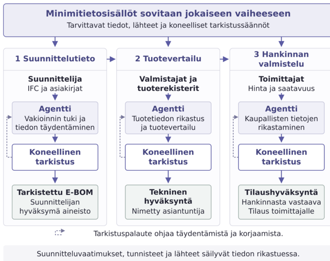
Kuva 1. Minimitietosisällöt, agenttinen rikastaminen ja koneellinen tarkistaminen suunnittelusta hankintaan. Tarkistettu aineisto toimii seuraavan työvaiheen lähtökohtana. Nimetyt asiantuntijat hyväksyvät tekniset valinnat ja tilaukset. Mukailtu lähteestä Torro (2026).
