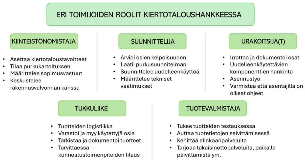
Kuva 5. Eri toimijoiden roolit tuotteiden uudelleenkäytössä (mukaillen Talotekninen teollisuus ja kauppa ry, 2025, Liite 1)
