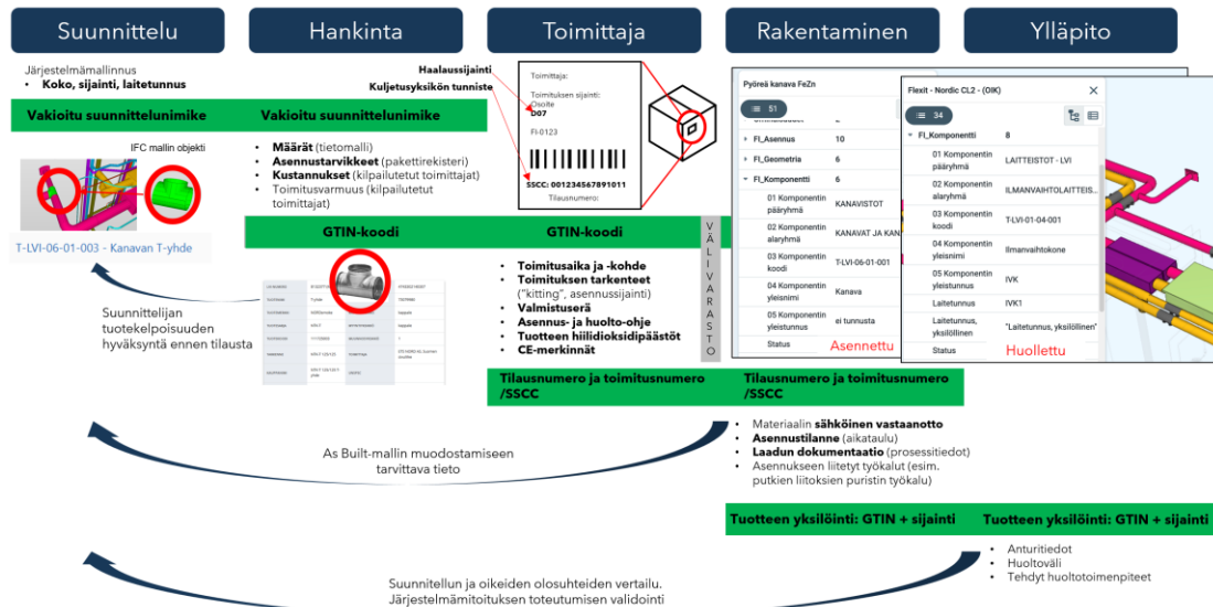
Kuva 19. MTS-toimitusketjussa toteutettu tiedon virtaus edellyttää tietoavainten hyödyntämistä eri vaiheiden tietojen linkittämiseksi toisiinsa (Ruottinen ja Ristimäki, 2025)
