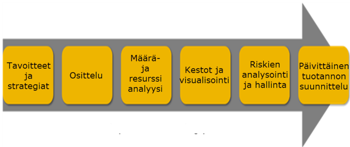
Kuva 3. Korkean rakentamisen tuotantojärjestelmän suunnittelun vaiheet
